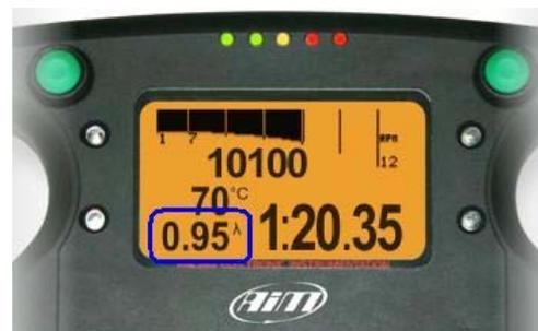
Accendendo **EVO3** il controller Lambda viene riconosciuto all'avvio ed inizia la procedura di warm-up della sonda. In questa fase il controller porta in temperatura la sonda (fino a circa 780 °C – 1436 °F). Per la durata del warm-up (circa 20-30 secondi), il valore di lambda visualizzato sul display è 1.00.
