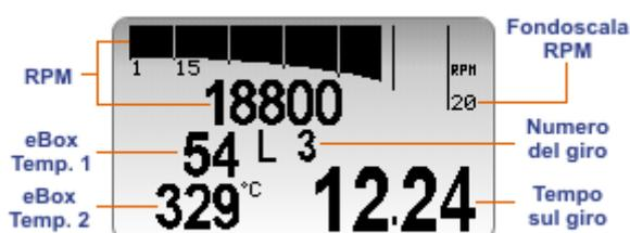
Premendo il tasto “ON/VIEW” sarà possibile visualizzare la velocità al posto del valore digitale RPM (immagine sotto).
