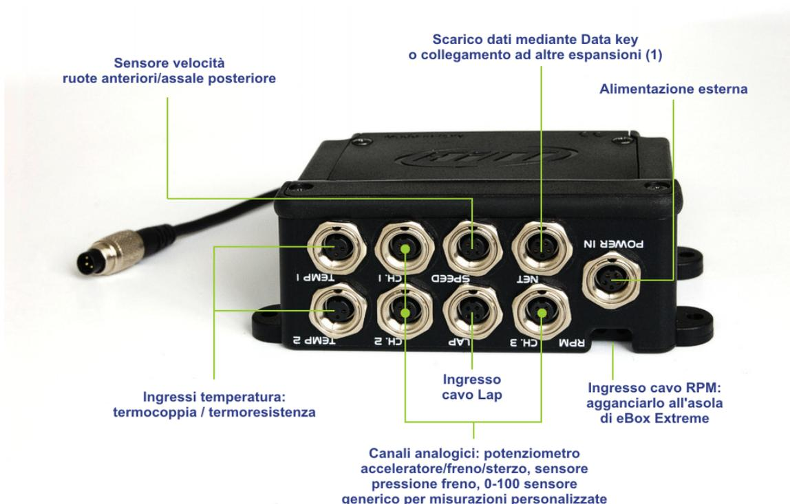
(1) Collegando un **Data Hub** a questo connettore è possibile remotare lo scarico dati ed ampliare ulteriormente i canali della **eBox**.
