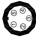
Connettore Binder 5 pin femmina Vista lato terminazioni di saldatura
