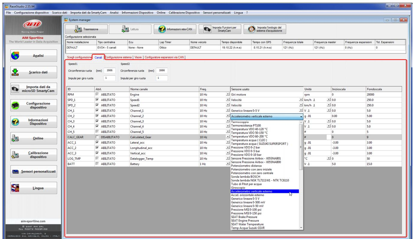
Il sensore viene impostato sul canale desiderato. Trasmettere la configurazione allo strumento premendo "Trasmissione".
