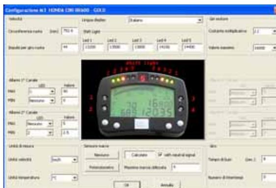
**Figura 34:** Race Studio 2 – Finestra di configurazione
