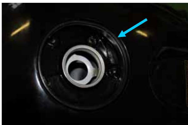
**Figura 26:** la guarnizione del serbatoio.
