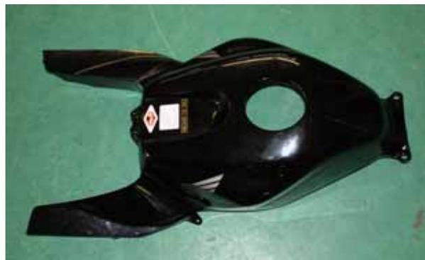
**Figura 13:** la carena del serbatoio è stata rimossa.
