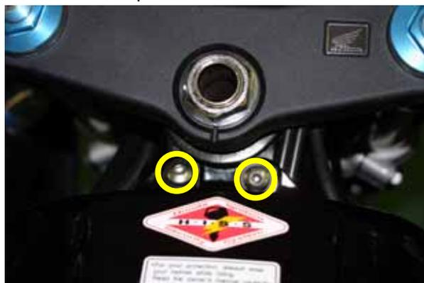
**Figura 4:** Le due viti frontali del serbatoio.
