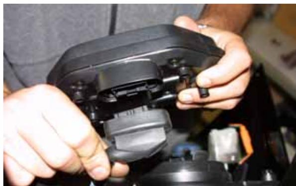
**Figura 19:** Sganciare il cablaggio di bordo.
