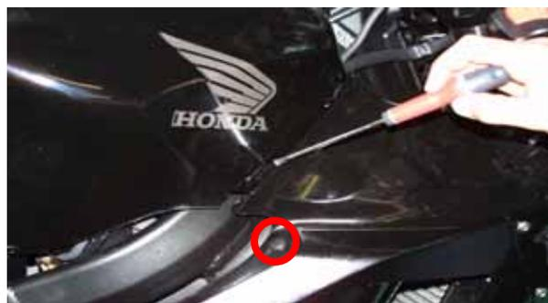
**Figura 12:** Posizione della spina sotto la carenatura.
