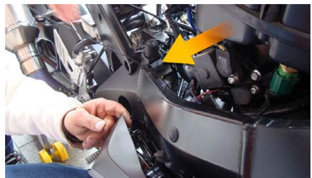
Figura 15: il cavo di massa scorre lungo il telaio
