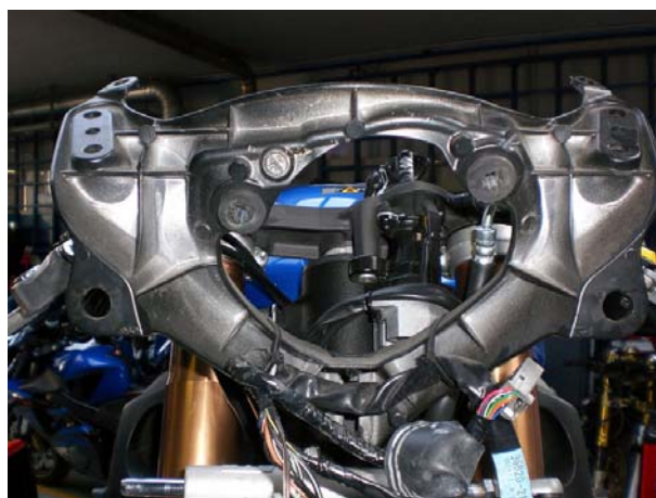
Figura 5: Rimozione del cruscotto di serie ultimata.
