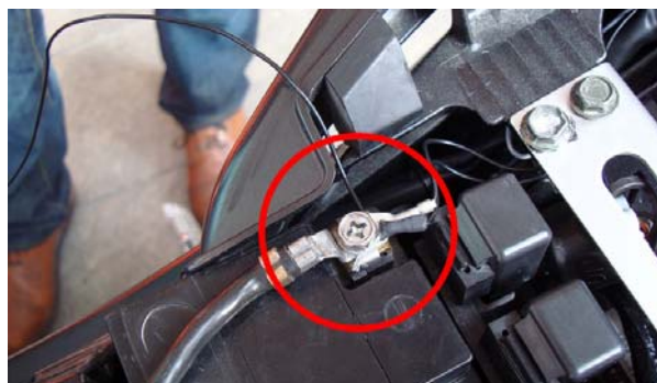
Figura 17: cavo di massa esterno correttamente collegato.
