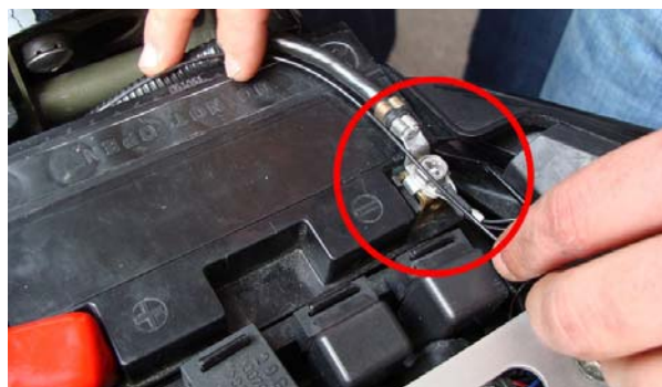
Figura 16: collegamento del cavo di massa al polo negativo della batteria.
