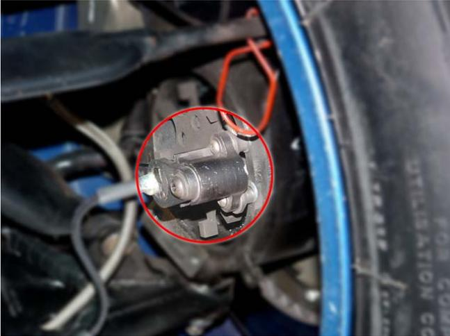
Si installino le due ruote foniche coassialmente alle ruote anteriori; si installino i supporti sul mozzo e si applichino ai suddetti supporti i sensori di velocità forniti col kit.
