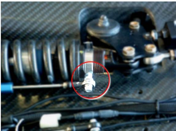
Particolare del fissaggio Uniball inferiore.
