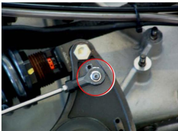
Particolare del fissaggio Uniball inferiore.
