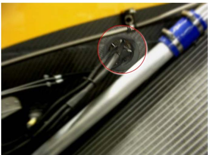
Particolare del “**passaggio uscita cellula**”; si consiglia di fissare la sezione posteriore del cablaggio acquisizione al cablaggio motore sotto il cassoncino di aspirazione.
