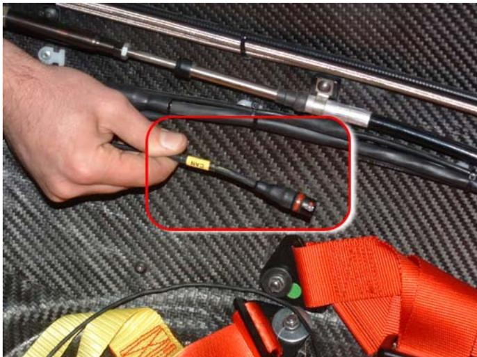
Il connettore a cui connettersi sul cablaggio motore è mostrato in figura e posizionato sotto la leva del cambio (lato destro della cellula).
